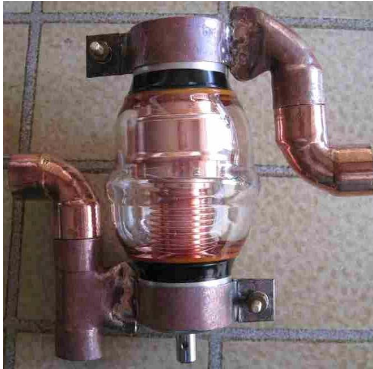
図 13 銀ハンダを施した銅製接合金具がある自作のコンデンサー・クランプ
