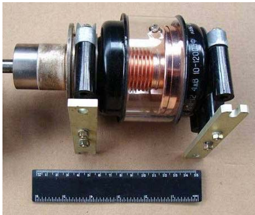
図 14 ロシア製軍様式の真空可変コンデンサーと付属クランプ
