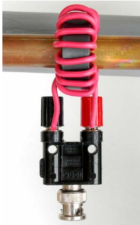
図 12 トランス結合の理論的かつ実用的な実現方法
