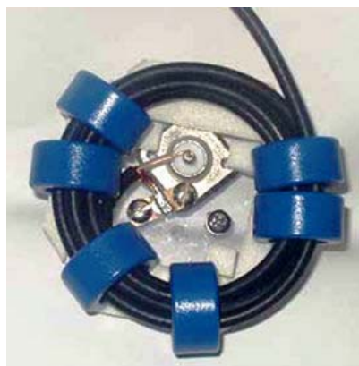
図 8 シンプルなコモンモード・チョークの構造
