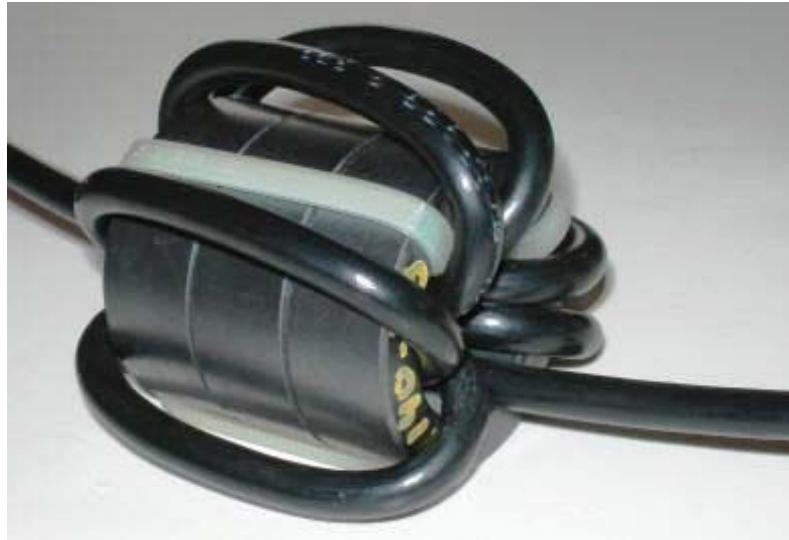
図9 コモンモード・チョークの別の構造
