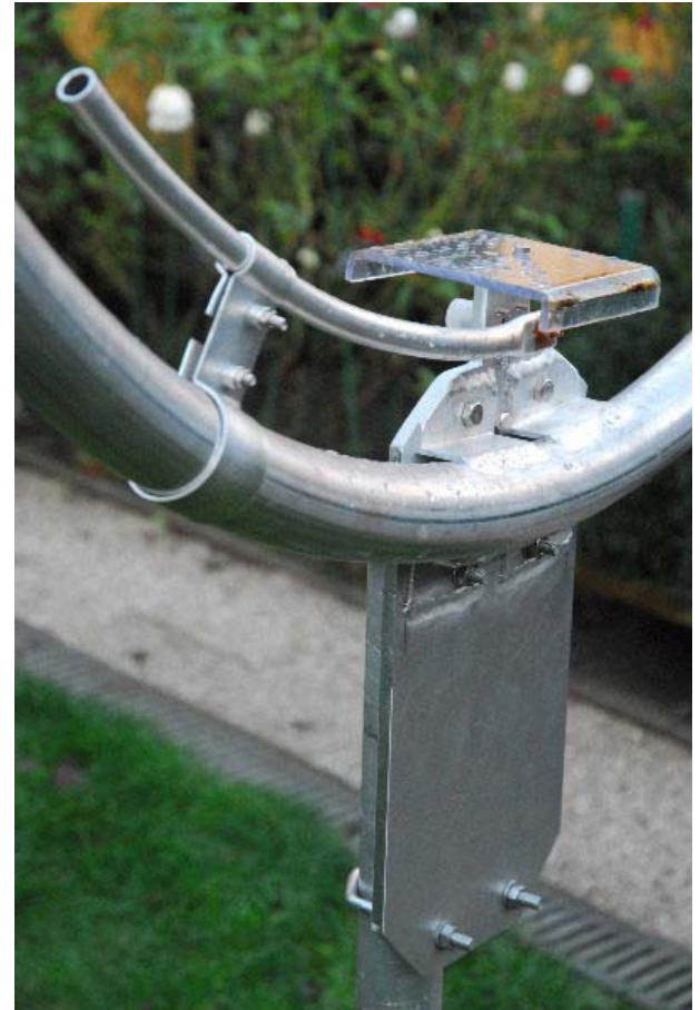
図 11 ガンマ給電の実装技法
