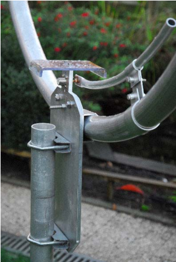
図 11 ガンマ給電の実装技法
