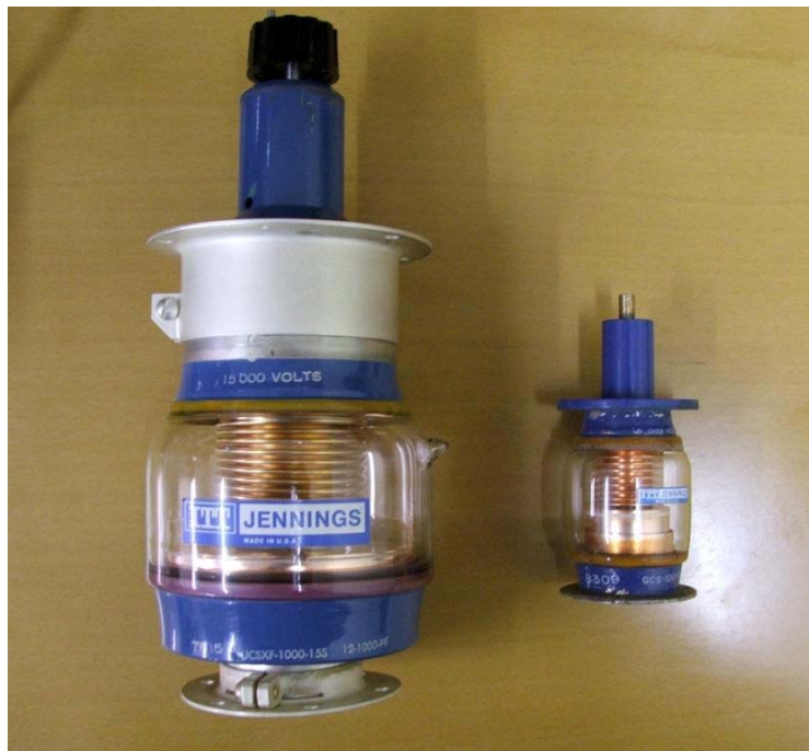
図2 低損失 可変真空コンデンサー
