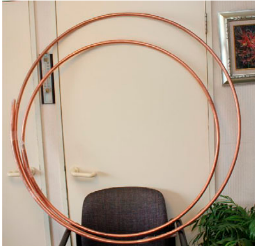
直径1mと1.2m, 20mm径の銅パイプ 「専用工具でRをつけるのはお手の物…」JA1QC山本さんの説明に聞き入る
