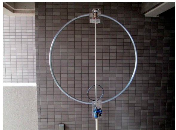
直径1mと1.2m, 20mm径の銅パイプ 「専用工具でRをつけるのはお手の物…」JA1QC山本さんの説明に聞き入る
