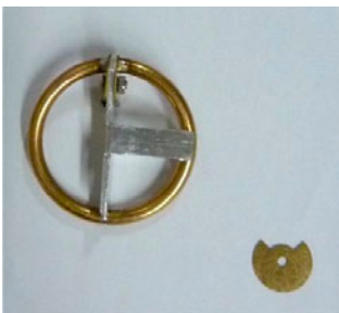
小型のバリコンを挿入する治具
