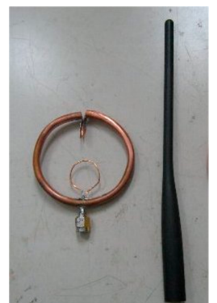
SWR=2 のバンド幅：5MHz(テフロン)と2MHz(空気)
