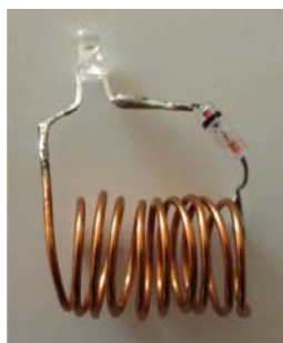
JG1UNE 小暮 (筆者) の作品。ツリー・アンテナと磁界検出器。全作品 430MHz 用
