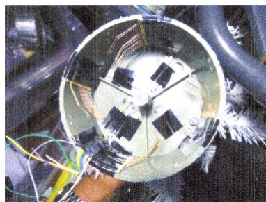
JR1OAO 中島さん作品「OAOのホワイトクリスマスツリー」星形MLAと回転ドラム式59個LED点滅機構、オルゴール8曲
