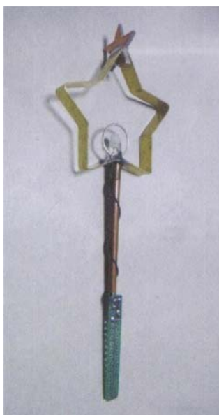
JR1OAO 中島さん作品「OAOのホワイトクリスマスツリー」星形MLAと回転ドラム式59個LED点滅機構、オルゴール8曲
