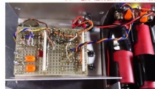
発振器周りはPPコン、時定数絡みはFilmコン、それ以外はチップコンを使用
