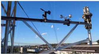
地上高13mの所に取り付けた風向計と風速計
