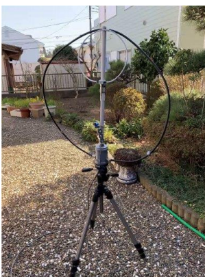
エレメントの長さは485mm Lアングルを使って支柱に固定できるように取り付け
