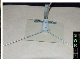
エレメントの長さは485mm Lアングルを使って支柱に固定できるように取り付け
