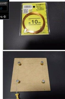
60x70のサイズで10mを巻くと36ターンとなります LCRメーターの読みで268μH
