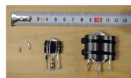
FT37-#43を8個使用×8 パッチコアを2個分を流用 大きい方で100W CW連続10分程度で温度上昇は25度程度 小さい方でも50W SSBなら使えそう
