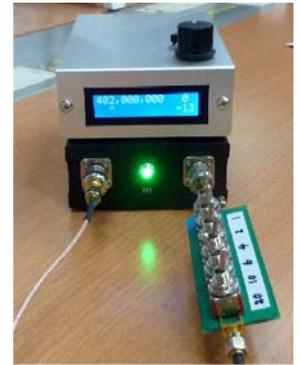
JA9BQE 橋場さんからは, 「50kHz~550MHzシグナルジェネレータ・コントローラ試作レポート」. 自作したアナログ方式シグナルジェネレータ, レベルメータは, 周波数・振幅の安定度や, 上限周波数の制限など, 課題があり, デジタル方式で試作. NWTシリーズはPCとUSB接続し, WinNWT4で周波数等を制御する仕様だが, スタンドアロンで使用可能(Arduino IDEのスケッチやC言語等でプログラミング). (回路図等の詳しい資料はDropbox).
