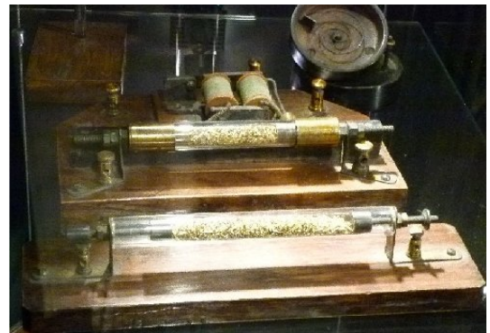
ガラス管に金属粉を封じ込んだ初期のコヒーラ(左)と, マルコーニの特許コヒーラ(いずれもマルコーニ博物館で撮す)
