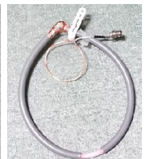
外導体で「シールド」した MLA(50MHz 用 2 種)
