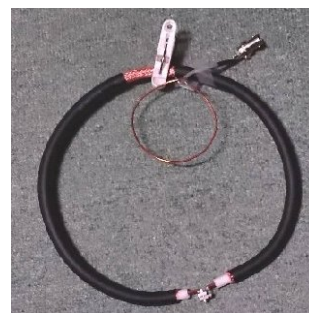
外導体で「シールド」した MLA(50MHz 用 2 種)
